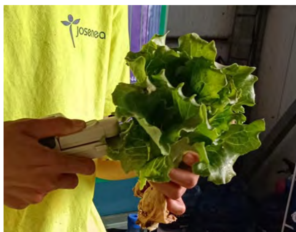
IMAGEN 1: Medición de clorofila mediante SPAD
