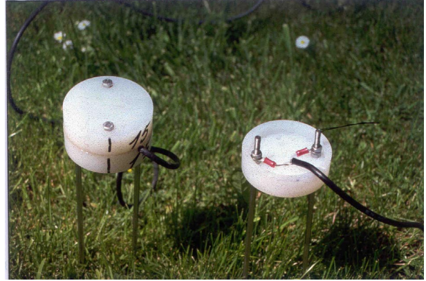
Foto 1. Aspecto general de la sonda diseñada y detalle de la conexión.
